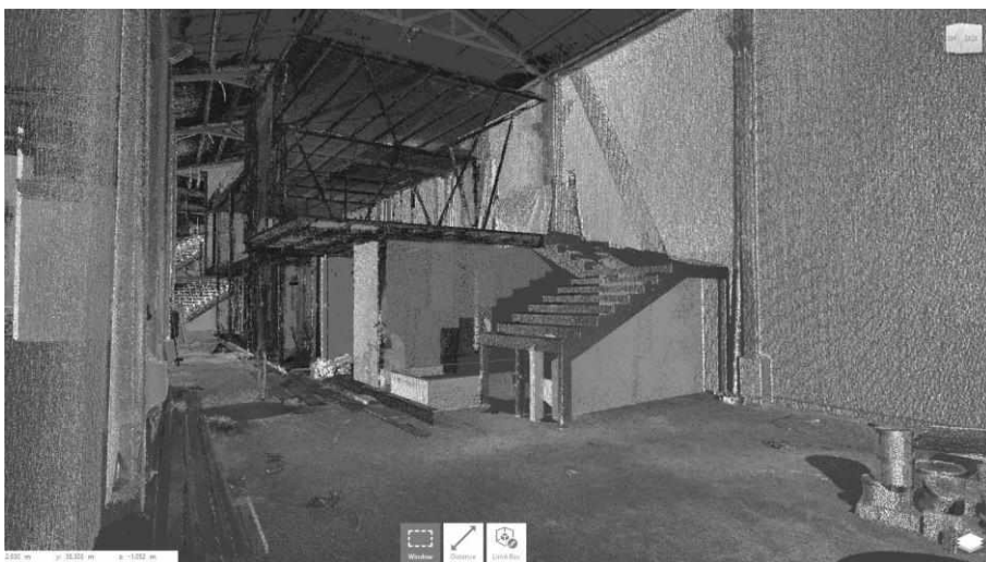
Hình 1.3 Mô hình đám mây điểm hiện trạng công trình
